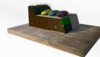
MUROS MECÁNICAMENTE ESTABILIZADOS
