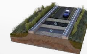
REFUERZO Y ESTABILIZACIÓN DE CAMINOS
