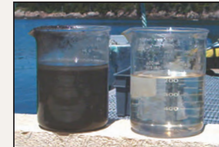
Agua con depósitos bénticos de Acuicultura antes y después del tratamiento Geotube®.
