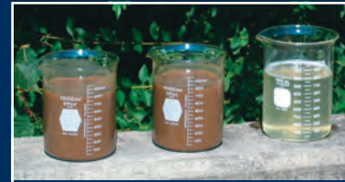
Lodo antes (izquierda) y después (derecha) del tratamiento con tecnología de filtración Geotube®.
