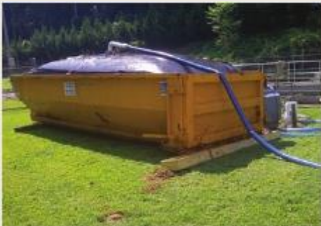
Sistema de deshidratación móvil Geotube® MDS
