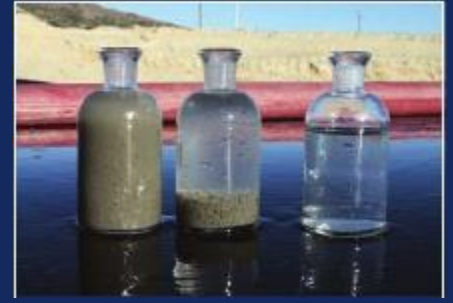
El lodo antes (izquierda) y después del tratamiento (derecha) con la tecnología de filtración de Geotube®.
