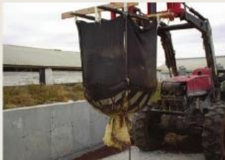
Bolsa tipo Geotube® V-bag
